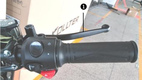
Der Vorderradbremshebel ❶ ist auf der rechten Seite des Lenkers montiert.
