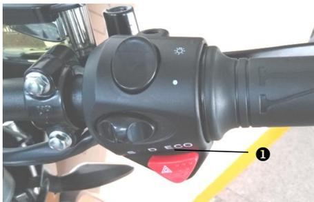
Der Fahrmodussschalter ❶ befindet sich am rechten Griffschalter.
