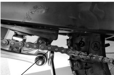
Schieben Sie die Kette um ❶ nach oben und prüfen Sie die Kettenspannung Ⓐ zwischen Kette und Kettenhalfter.
