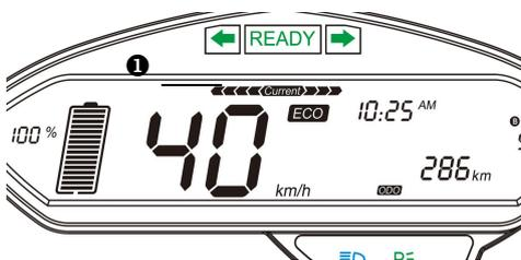
Die Anzeige des Stroms ❶ zeigt Echtzeitstrom in Form einer Statusleiste an. Sie können den aktuellen Echtzeitstrom in der Statusleiste grob ermitteln.
