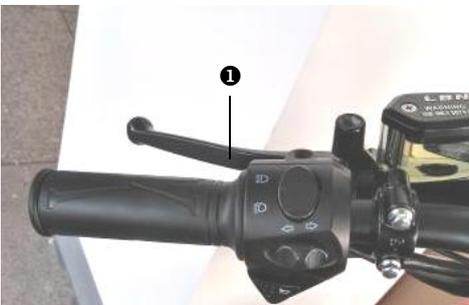
Der Hinterradbremshebel ❶ ist auf der linken Seite des Lenkers montiert.
