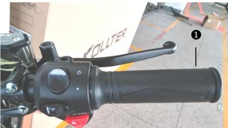
Der Griff des elektrischen Schalters ❶ befindet sich auf der rechten Seite des Lenkers.
