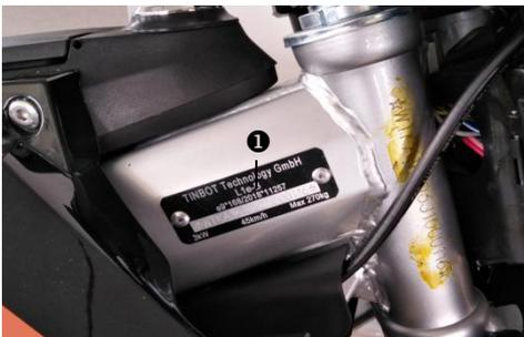
Das Typenschild ❶ ist an der rechten Vorderseite des Fahrgestells montiert.
