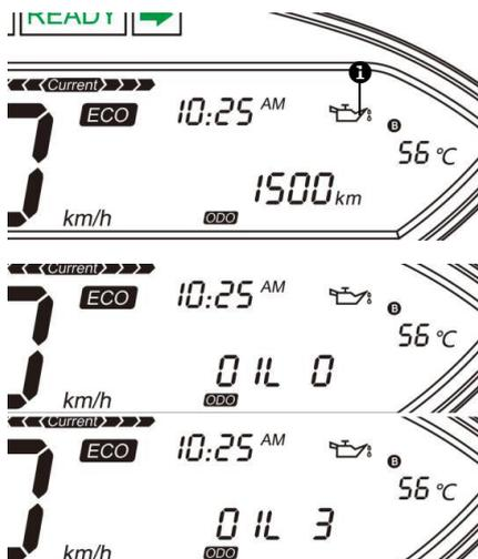
Je nach Kilometerstand und Fahrzeit, werden Sie automatisch daran erinnert, dass das Getriebeöl ausgetauscht werden muss. Sie können die Erinnerung nach dem Ölwechsel manuell löschen oder von unserem Servicepersonal löschen lassen.
