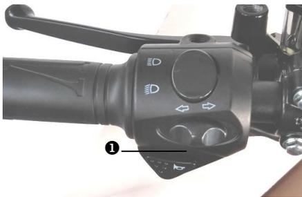
Der Blinkerschalter ❶ befindet sich am linken Griffschalter.
