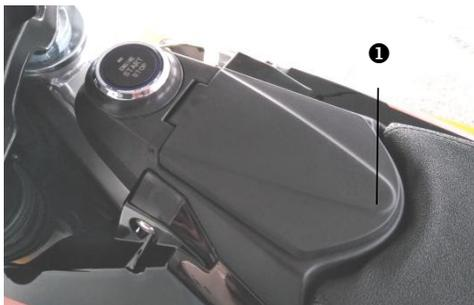
Die Ladestation befindet sich vor dem Sitzkissen und der Ladendeckel kann durch leichtes Drücken der Rückseite des Ladendeckels ❶ geöffnet werden.
