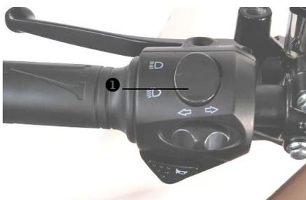
Der Dimmschalter ❶ befindet sich am linken Griffschalter.
