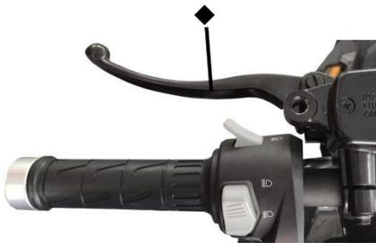
hinterer Bremsgriff ◆ Wird auf der linken Seite der Lenkstange installiert.
