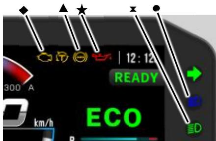
1. Wenn **◆** leuchtet, bedeutet dies, dass ein Fehler im Betrieb des Fahrzeugs vorliegt. Bitte wenden Sie sich an einen autorisierten Händler.
