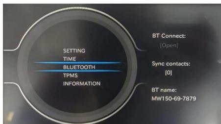
Mobiltelefon-Bluetooth: Sie können Bluetooth unabhängig einstellen und wechseln sowie Kontakte und Bluetooth-Namen synchronisieren.
