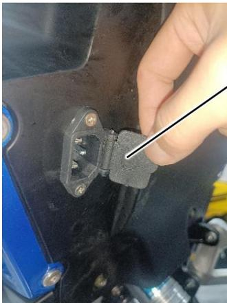
Der andere Ladeanschluss befindet sich unter der Vorderseite der hinteren Schutzplatte und der Ladeanschluss kann geöffnet werden, nachdem die Ladeabdeckung angehoben wurde.
