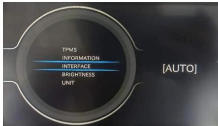
Bildschirmumschaltung: Es können drei Bildschirmmodi ausgewählt werden, nämlich Nachtmodus, Tagmodus und Automatikmodus. Im Automatikmodus wechselt es je nach Intensität des Umgebungslichts automatisch in den Nacht- und Tagmodus
