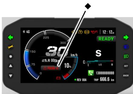
Wenn das Motorrad ausfällt, wird der entsprechende Fehlercode im Fehlercode-Anzeigebereich angezeigt
