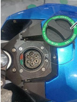
RS1 bietet zwei Lademöglichkeiten, eine befindet sich vor dem Handschufach ♦ und die Ladeabdeckung kann nach Drehen zum Laden geöffnet werden.
