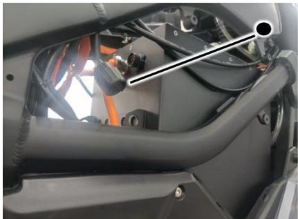
2. Der Zustand des Batteriekommunikationskabels während des Transports ist auf dem Foto dargestellt ●
