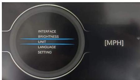
Einheiteneinstellung: Die Messeinheit des Instruments kann unabhängig eingestellt werden
