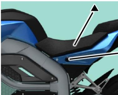
Die Sitzbankverriegelung ◆ befindet sich links an der Fahrzeugkarosserie.
