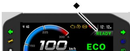
READY (bereit zum Fahren): Diese Leuchte zeigt an, dass das Fahrzeug fahrbereit ist, wenn sie aufleuchtet.
