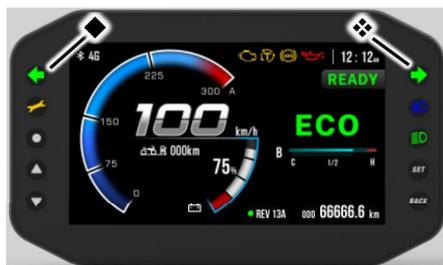
1. Bei eingeschaltetem linken Blinker leuchtet und blinkt der linke Pfeil zusammen mit dem Blinker.
