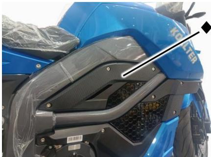
1. Verwenden Sie einen Sechskantschlüssel, um die drei Schrauben zu entfernen, mit denen die rechte Innenverkleidung befestigt ist ◆
