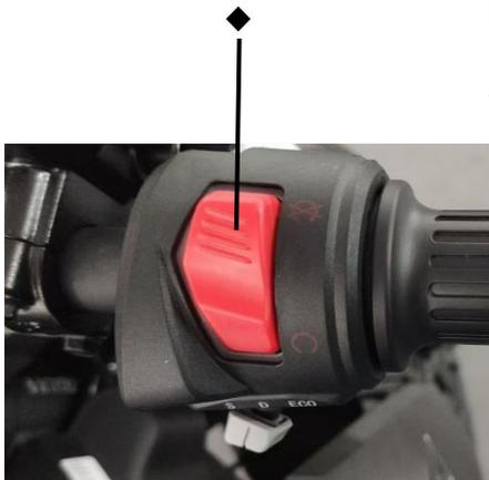
Wenn ☒ gedrückt wird, befindet sich das Fahrzeug im P-Gang, die „ P “ -Anzeige leuchtet auf der Instrumententafel und das Fahrzeug kann nicht gefahren werden.
